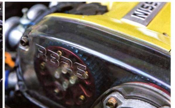
エンジンはRB30ブロックにRB26ヘッドを搭載したツインカム3リッターユニットに換装。等長エグゾーストと6連スロットルスポーツインジェクションによって、鋭い吹け上がりを実現するNAエンジンとなっている
