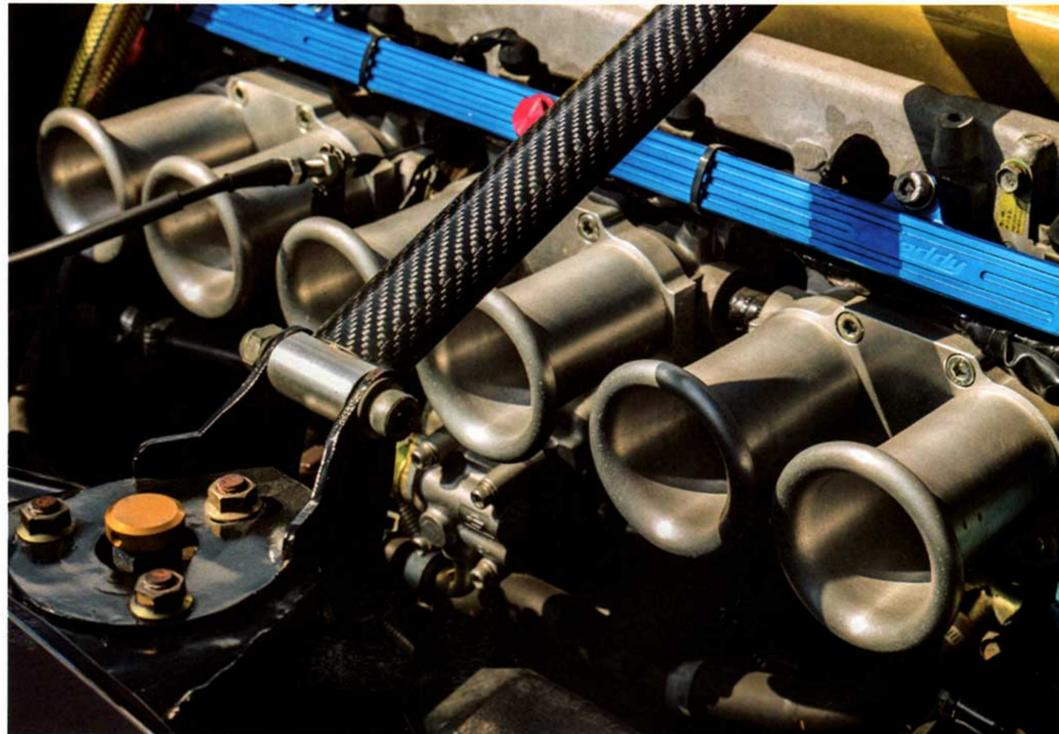
6連スロットルに備わるファンネルが並ぶエンジンルーム。燃料供給はMO TEC M8で制御する。剛性を高めるカーボン製タワーバーも装着
