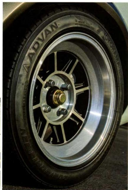
撮影車両はホイールを純正のスティール製から、ハイテレーシング製アルミホイールに変更している
