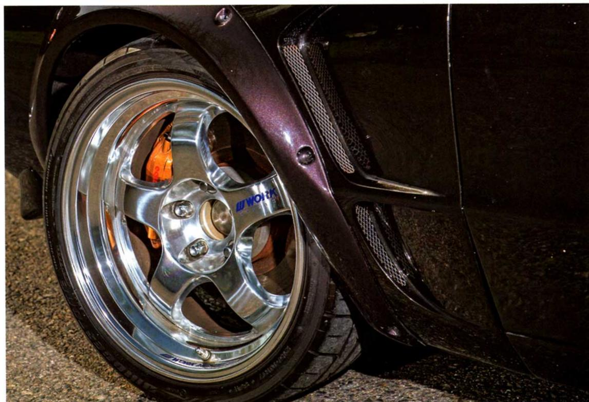
ブレーキは制動性を高めるためR34のゴールドブレンボを装着。ホイールはWORKマイスターS1に換装。フロント17×9J、リアに18×12Jの異径セットアップとなっている
