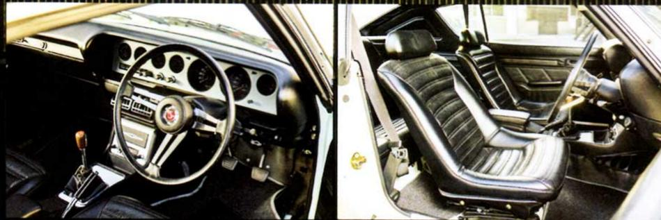
GT-Rのシートはリクライニング機構を持たないフルバケットシートが標準装備。後席にはシートごとフロント側に倒して乗り込む
